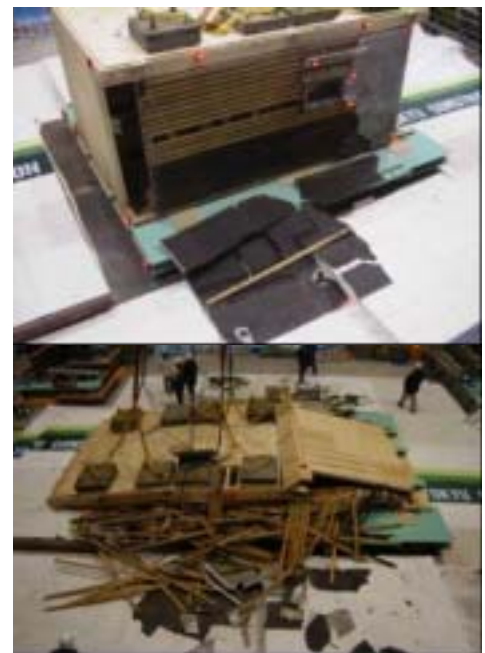
写真 2 移築した構面試験体の崩壊過程
