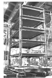
(a) 試験体 (スパン約 2m × 高さ約 5m)
