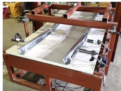
写真 3 LGS 間仕切壁の実験（載荷後）
