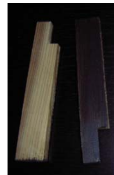
写真-4.160 落下した込み栓
