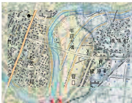
(黄色：新期砂丘堆積層、白：沖積平野堆積層) (柏崎市,刈羽村の地形・表層地質状況(出典:新潟県土地分類基本調査図)の表層地質と地形図の調査地域部分を重ねあわせたもの)
