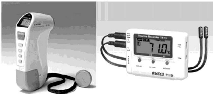
図 10 温度センサーの例(左:放射温度計、右:ロガー一体型温度センサー)
