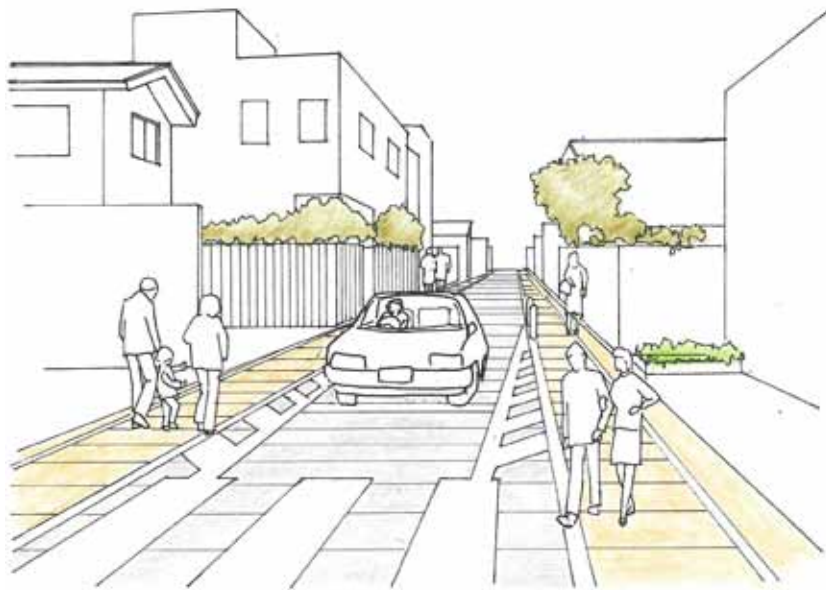
イメージ狭さくを用いて車の速度抑制を狙った歩車共存道路
