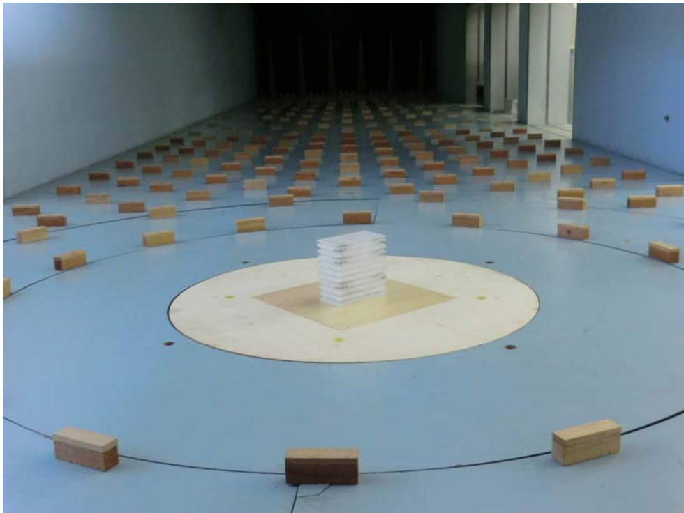
図 3.3.1.6 風洞内模型設置状況
