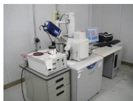
写真1 走査型電子顕微鏡 S-3400N HITACHI 製
