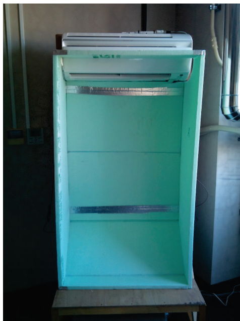
図 7.2.6.2 風量測定ボックスを吹き出し口に取り付けたところ
