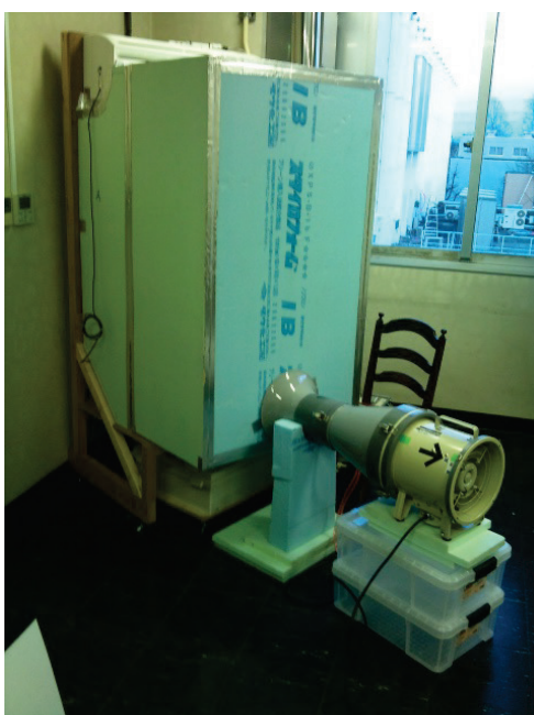
図 7.2.6.4 風量測定ボックスを吹き出し口に取り付け気密測定器により風量測定を実施しているところ
