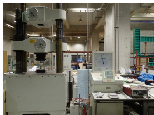
写真 2.4.1-2 圧縮強度試験機の外観(左：負荷容量 1000kN、右：2000kN)
