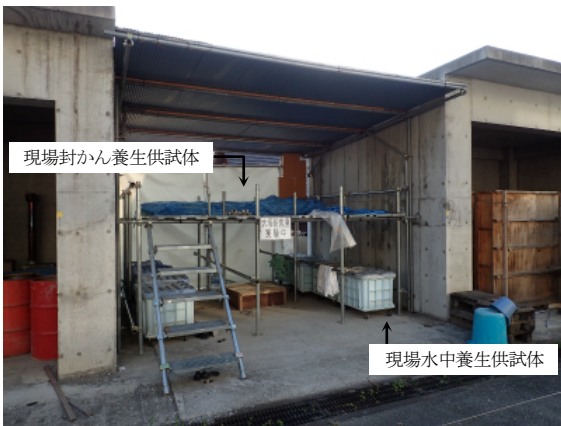
現場水中養生供試体および 現場封かん養生供試体の養生場所
