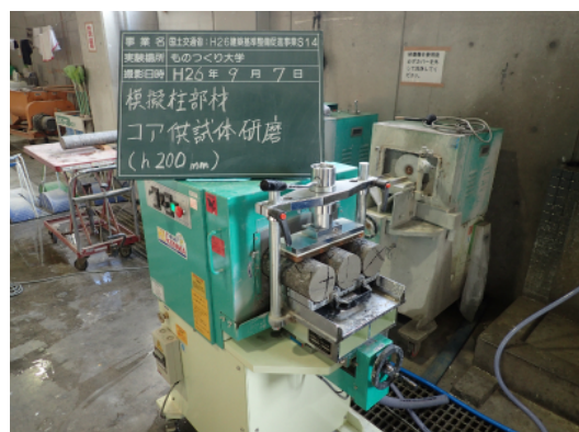
供試体端面の研磨の状況
