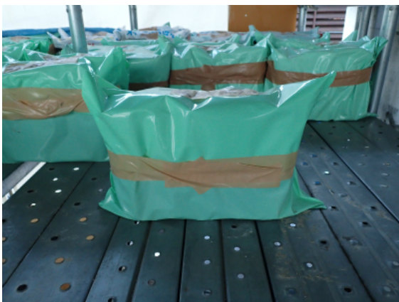
現場封かん養生供試体の養生状況
