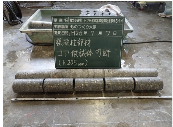
模擬柱部材から採取したコア供試体の切断の状況
