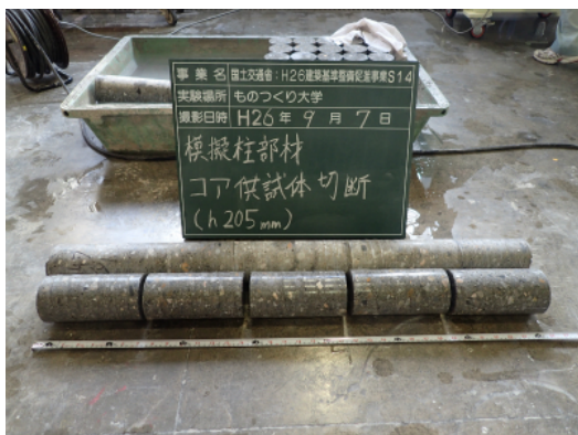
コア供試体の切断の状況
