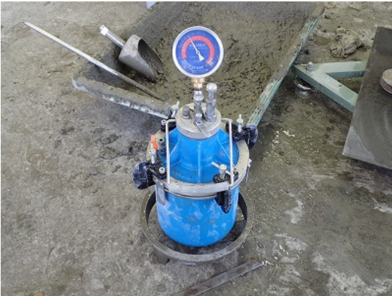
空気量試験の状況
