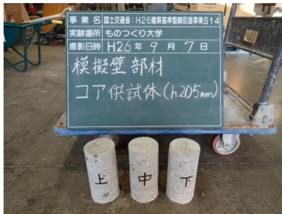
模擬壁部材から採取したコア供試体
