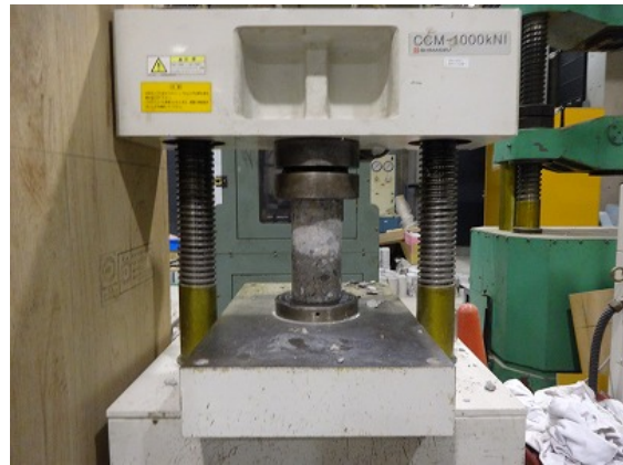
圧縮強度試験の状況
