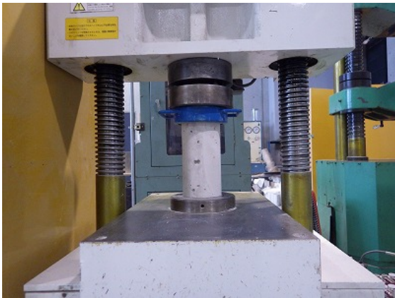
アンボンドキャッピングとした供試体の圧縮強度試験の状況
