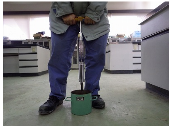
凝結時間試験の状況
