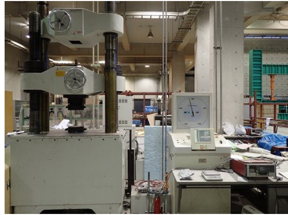
圧縮強度試験機(負荷容量：2000kN)の外観
