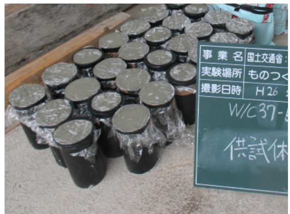
管理用供試体の作製状況
