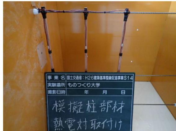
模擬柱部材の熱電対の取付け状況
