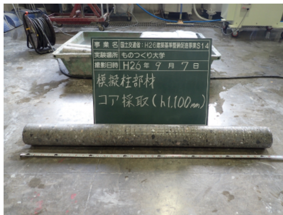
模擬柱部材から採取したコア供試体
