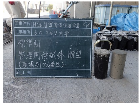
管理用供試体の型枠の脱型
