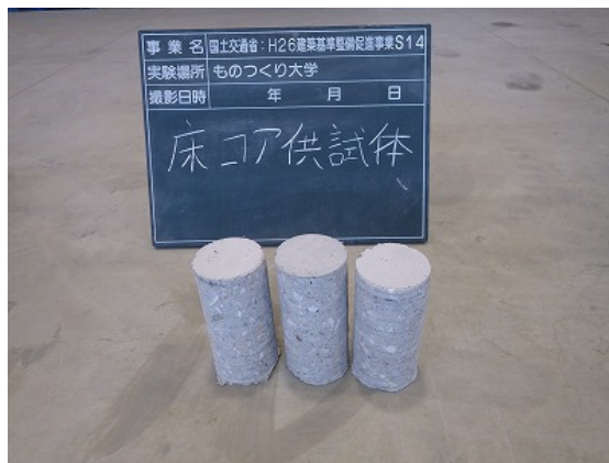
模擬床部材から採取したコア供試体
