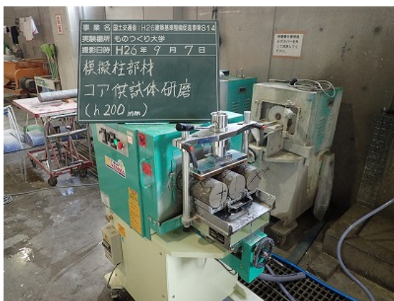
コア供試体および管理用供試体の端面の研磨による仕上げ状況
