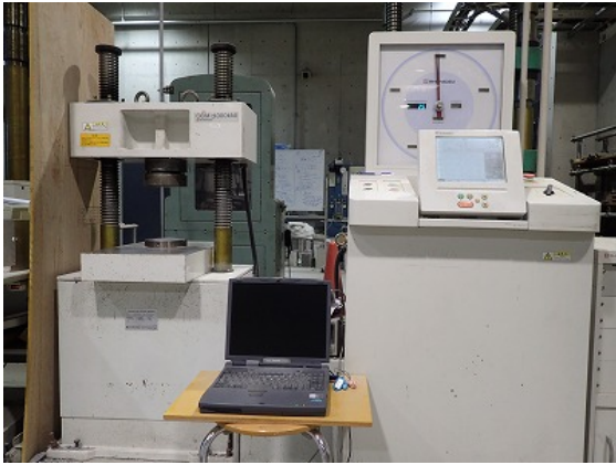
圧縮強度試験機(負荷容量：1000kN)の外観
