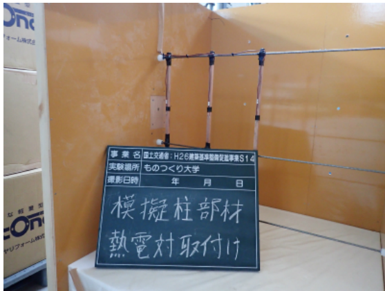
模擬柱部材の熱電対の取付け状況
