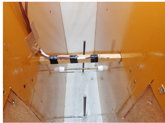
模擬壁部材の熱電対の取付け状況
