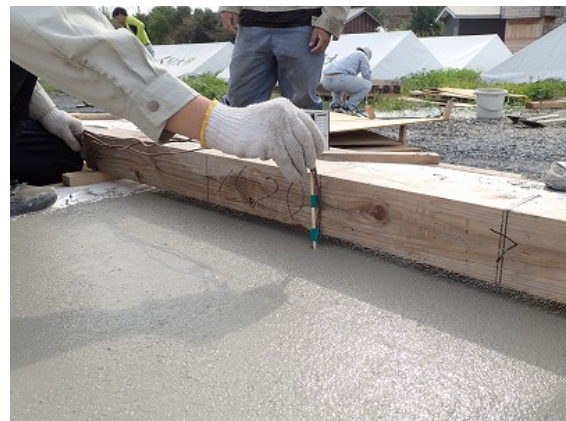
模擬床部材の熱電対の取付け状況
