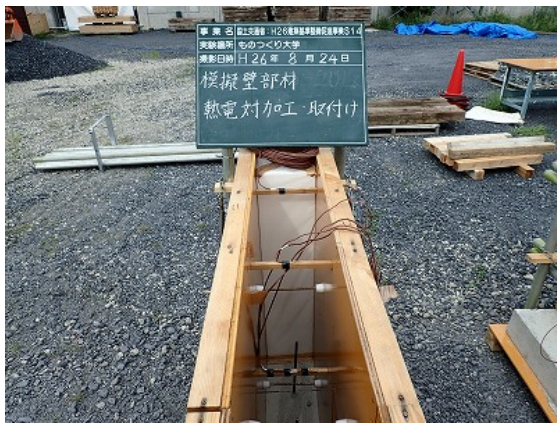
模擬壁部材の熱電対の取付け状況
