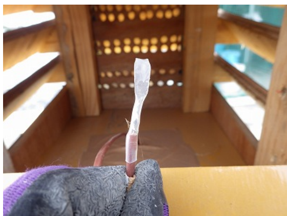
熱電対の先端部
