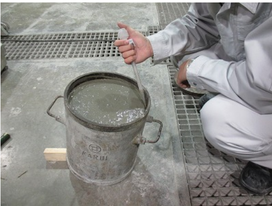
ブリーディング試験の状況
