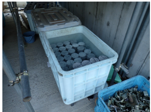
現場水中養生供試体の養生状況
