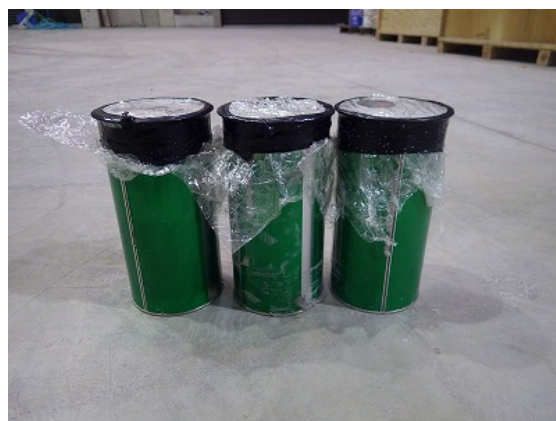
付写真 4-6 管理用供試体(簡易断熱養生)
