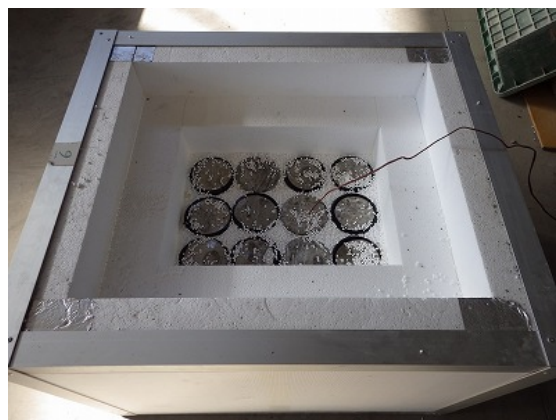
付写真 5-4 簡易断熱養生の状況
