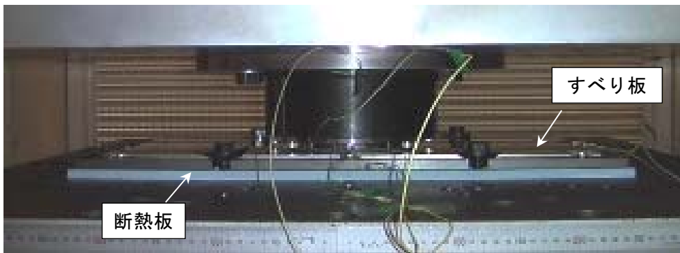
写真 1.2-2 弾性すべり支承の試験状況 1.2-1)
