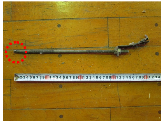
写真 5.8.2-18 吊り材(円内は溶接痕)
