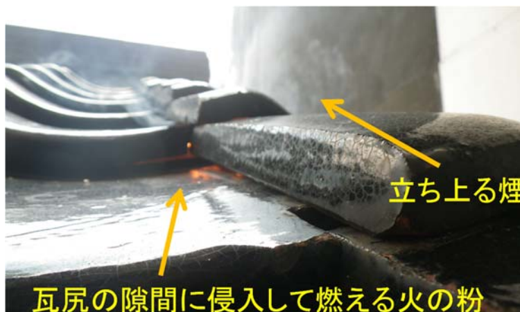
写真 5.3.2 風速 10m/s 実験時の瓦屋根上部
