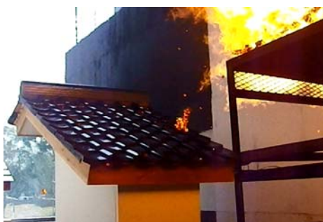
写真 5.3.1 有風下での火の粉による出火実験の様子
