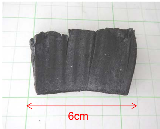
写真 4.2.2.9 採取したサンプル (外寸 6.5cm×4.5cm、厚さ : 1cm、重さ : 6.9g)
