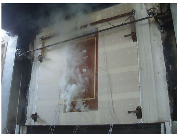
写真 1.2-3 部材実験(特定防火設備)
