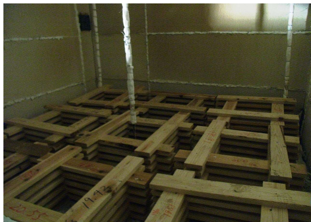
写真 1.5-1 収納可燃物の設置状況
