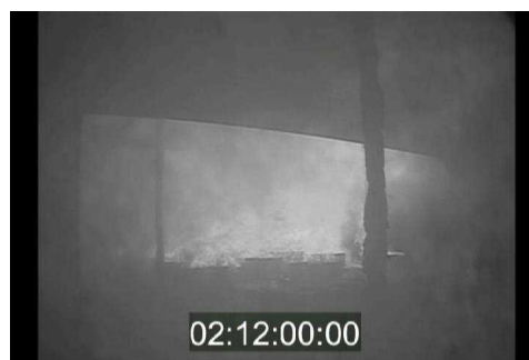
写真 3.7.2-16 2階室内全体への延焼
