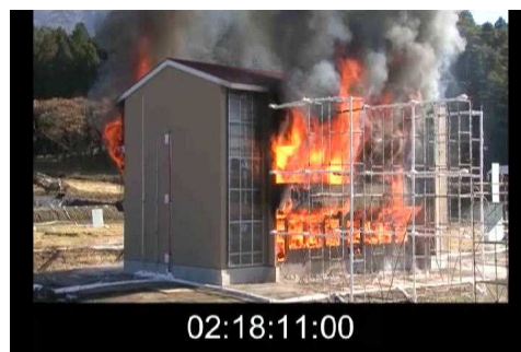
写真 3.7.2-18 屋根を超える高さの火炎
