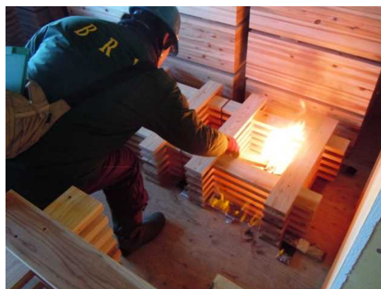
写真 3.4.3-2 クリブへの点火方法
