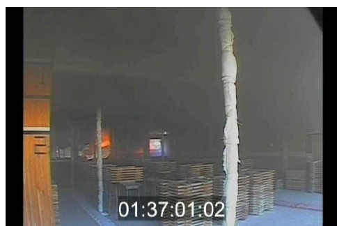
写真 3.7.2-11 窓ガラスからの煙の流入
