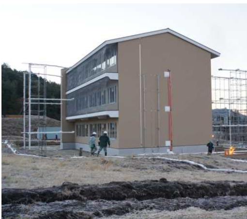
a) 熱流束計の設置状況
