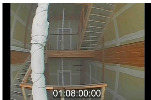
写真 3.7.2-21 階段室への煙の流入
