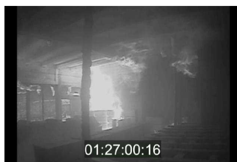
写真 3.7.2-7 出火室全体への延焼
