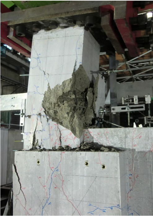
写真・図 5.3.5 最終破壊状況及び Q-R 関係(試験体 C-1)
