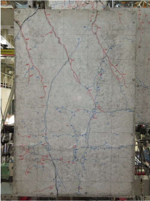
写真・図 5.3.13 最終破壊状況及び Q-R 関係 (試験体 D-1)
