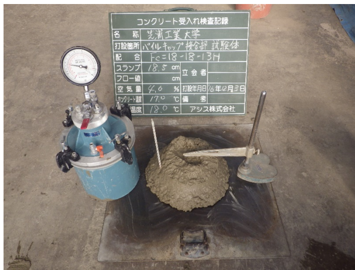
写真 5.2.7 コンクリート受入れ調査記録（打設日 2016 年 12 月 3 日）
