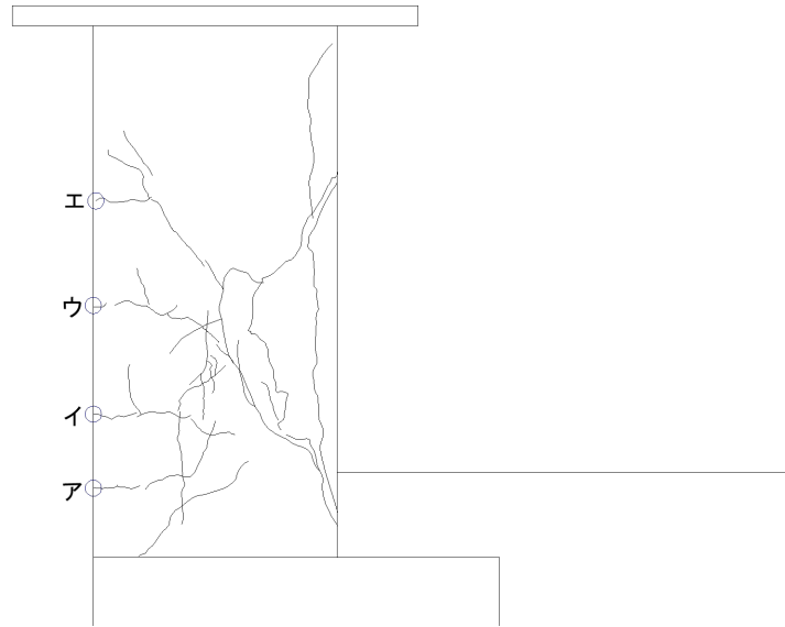
図 5.3.228 柱ひび割れ幅測定位置(試験体 C-1 正載荷)
