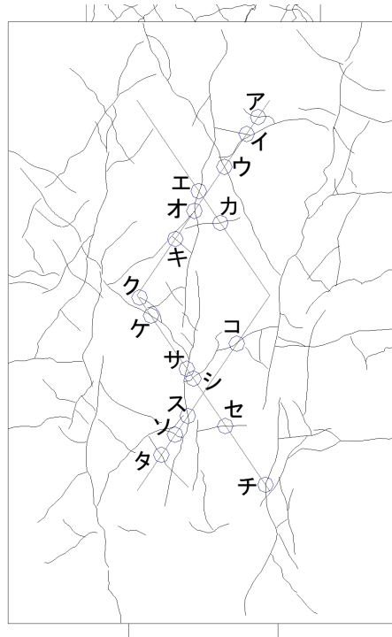
図 5.3.188 パイルキャップひび割れ幅測定位置 (試験体 A-1 正載荷)
