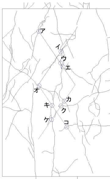
図 5.3.214 パイルキャップひび割れ幅測定位置 (試験体 A-3 負荷)
