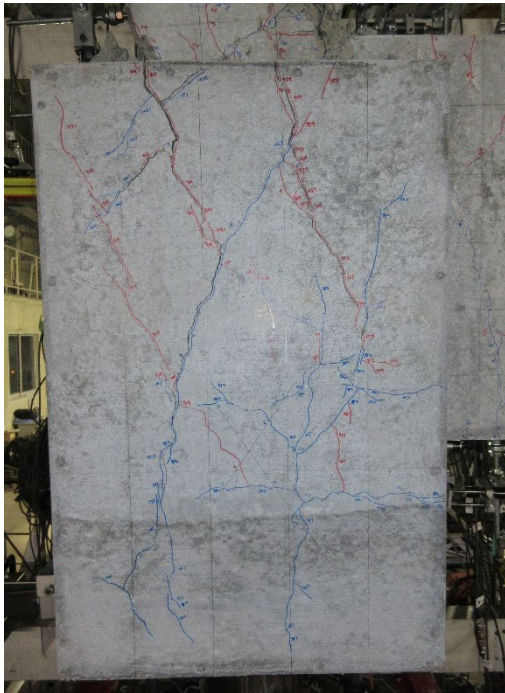
写真・図 5.3.14 最終破壊状況及び Q-R 関係 (試験体 D-2)
