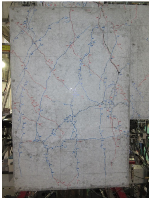
写真・図 5.3.11 最終破壊状況及び Q-R 関係(試験体 A-7a)
