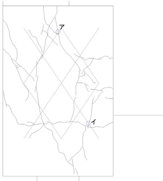
図 5. 3. 236 パイルキャップひび割れ幅測定位置 (試験体 C-1 負荷荷)
