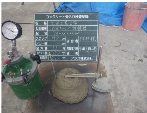
写真 5.2.8 試験体 A-7a, A-7b, D-1, D-2 コンクリート受入れ調査記録 (打設日 2018 年 9 月 10 日)
