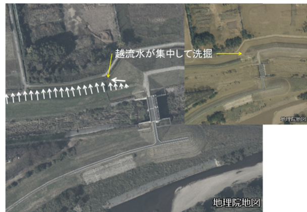
写真-5.2.3.7 決壊箇所堤防平面形状 (背景地図出典：国土地理院電子国土 Web)
