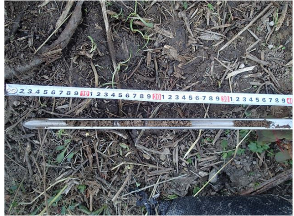
写真-5.2.18.12 阿武隈川下流右岸 13.2KP 陥没直下の土
