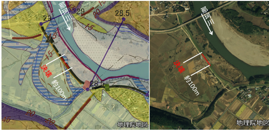
図-5.2.4.2 被災箇所（那珂川右岸 28.6KP）（背景地図出典：国土地理院電子国土 Web）
