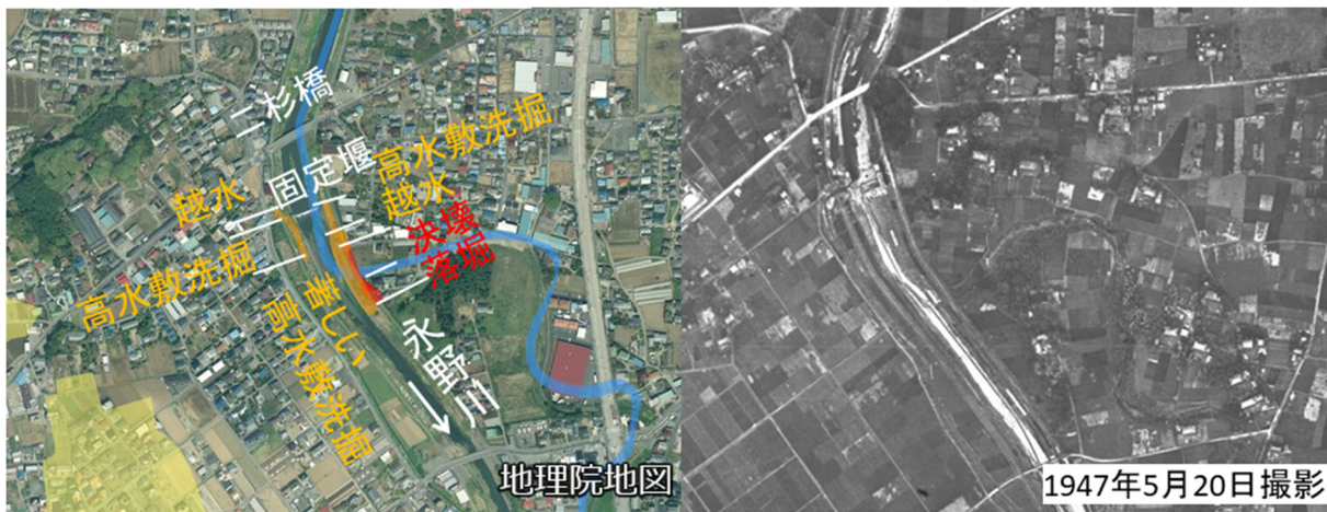
図-5.2.8.7(3) 決壊箇所 明治期の低湿地（左） 1947/5/20 撮影空中写真（右） （背景地図出典：国土地理院電子国土 Web）
