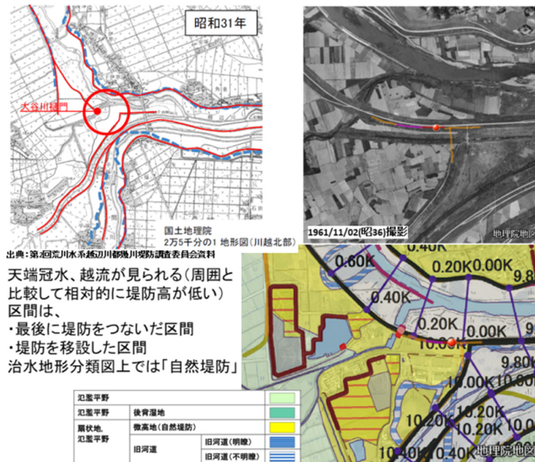
図-5.2.3.4 決壊箇所区間の築堤時期等 (背景地図出典：国土地理院電子国土 Web)
