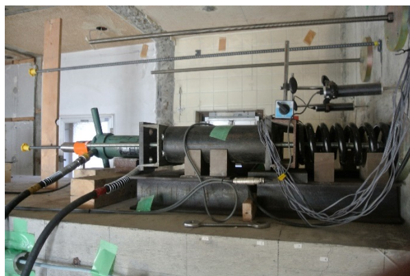
写真 4.5.4.1 長期クリープ試験装置(加力時)
