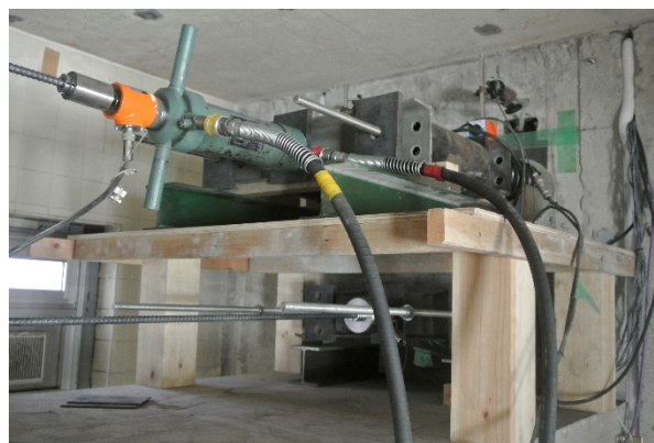
写真 4.5.4.1 長期クリープ試験装置(加力時)
