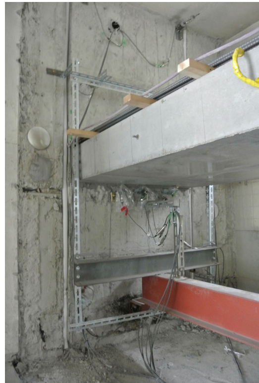
図4.5.4.3 201, 101号室 階段室側壁の変形測定方法
