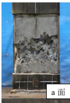
(j) a面柱脚部 内部コンクリート
