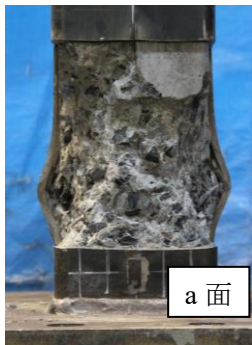
(j) a 面柱脚部 内部コンクリート
