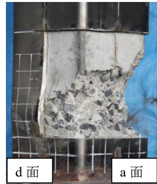
(k) d-a 面柱脚部 内部コンクリート
