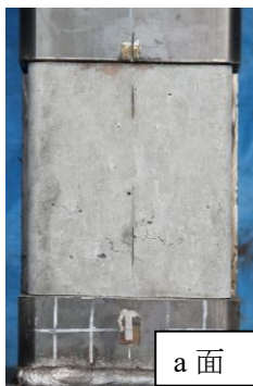
(i) a 面柱脚部 内部コンクリート
