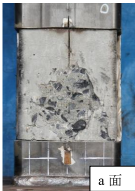
(i) a 面柱脚部 内部コンクリート
