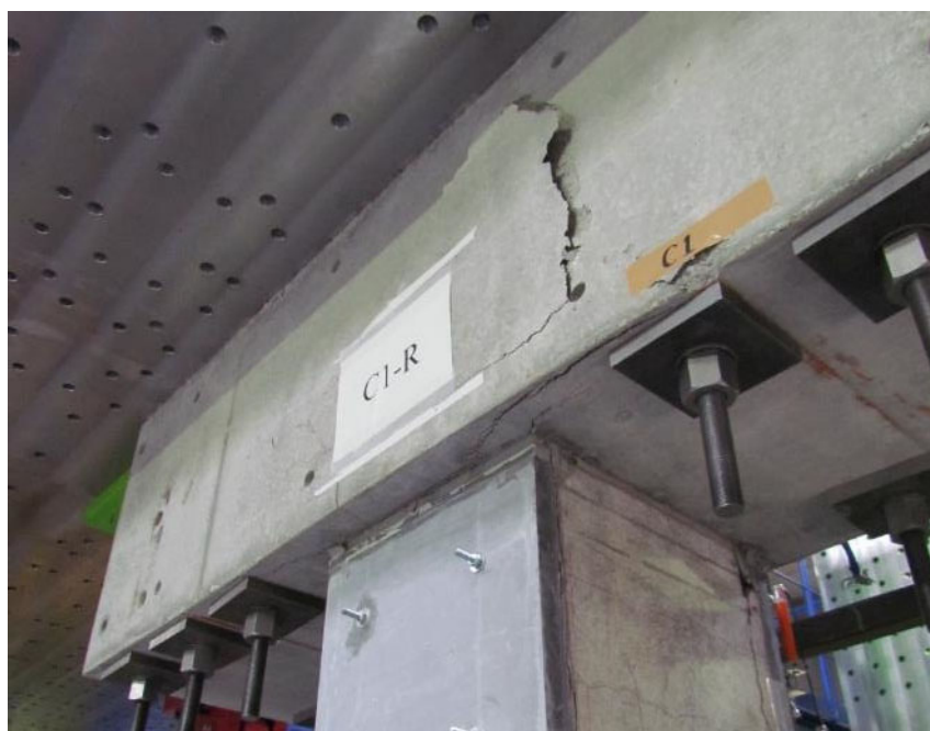
(d) 試験体正面南西方向からの写真 UFC パネル突き上げによるスタブコンクリートの破壊 図 3.3.1-5 損傷状況
