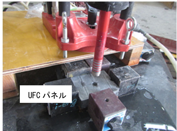
(b) UFCパネルの固定状況
