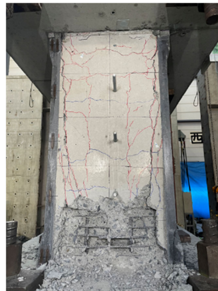
図 6.3.3-1(j) 最終破壊状況 (C2-UFC1)
