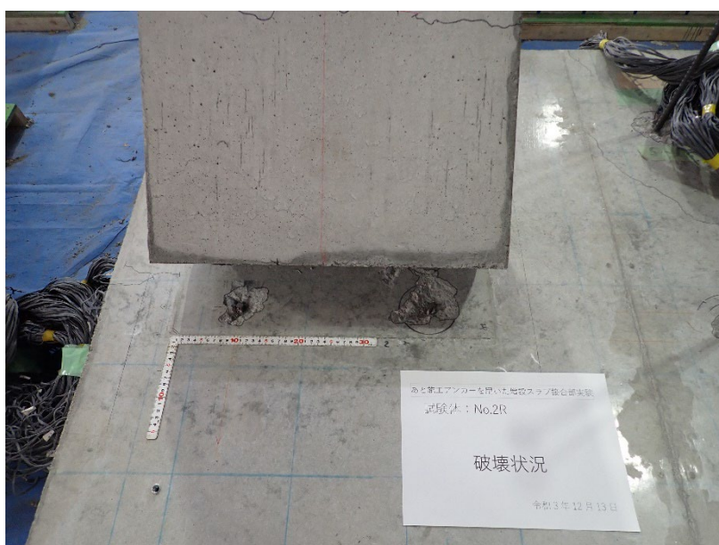
図 3.4.6-15 ひび割れ図および最終破壊状況写真 (No.2R)
