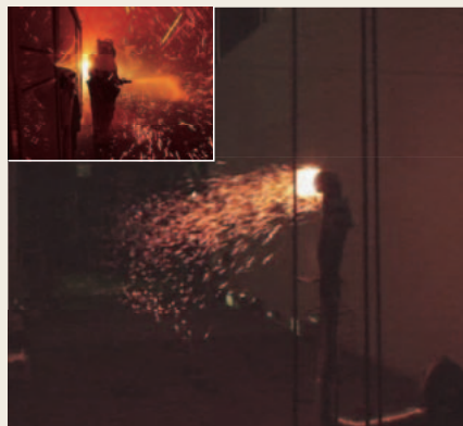
火の粉発生装置 (左上は実火災での火の粉)
