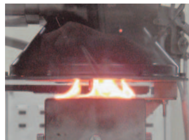
写真6 ポリマーセメントモルタルの発熱性試験の状況
