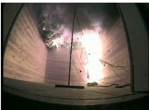
■ 写真6 小規模居室における炎の燃え拡がり(この直後に炎と煙が床近くまで降下して居室全体に燃え拡がった)
