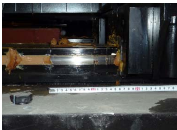
図 4.17-2 直動転がり支承の移動跡
