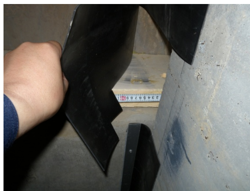
(b) こすれ痕に相当するカバーの変形
