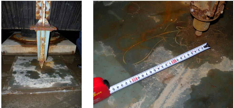
図 4.2-7 野書き式変位計による記録
