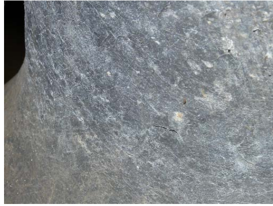
写真 5. 5. 1-52 鉛ダンパー表面の微細な亀裂
