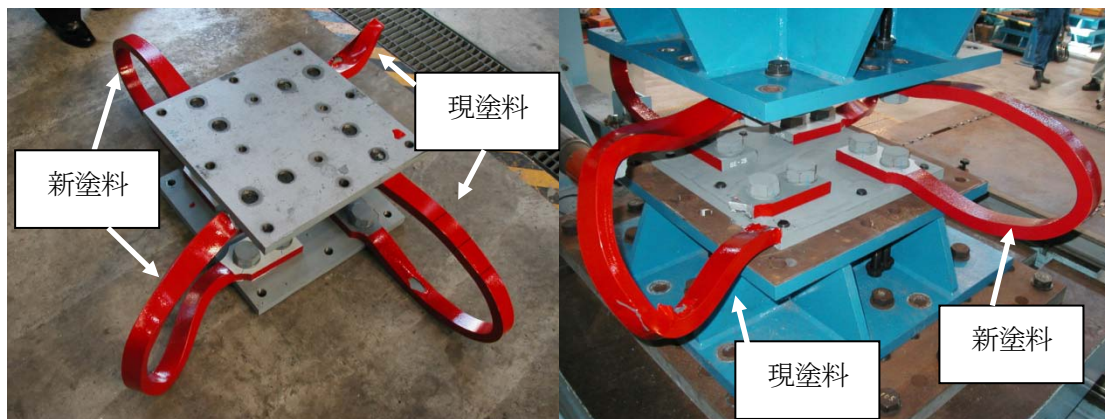
写真 5.5.3-3 塗装の種類による加力試験後の様子 5.5.3-13)
