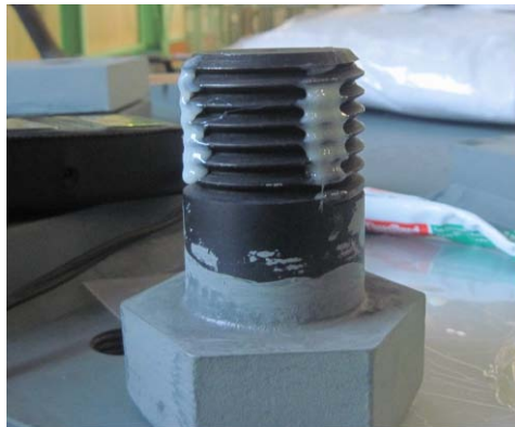
写真 5.5.3-2 ボルト部への接着剤塗布状況 5.5.3-13)
