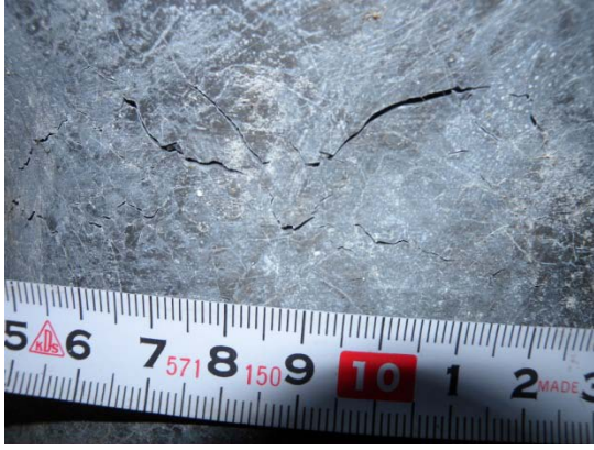
写真 5. 5. 1-52 鉛ダンパー表面の微細な亀裂
