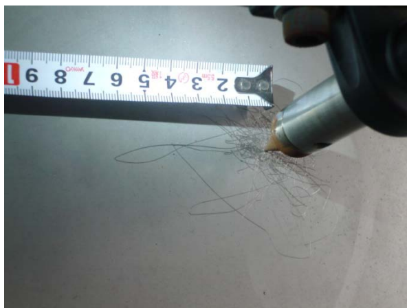
写真 5.5.1-51 罫書き式変位計の免震層変位記録
