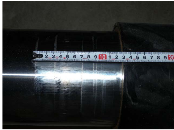
写真 5. 5. 1-48 オイルダンパーの変位跡
