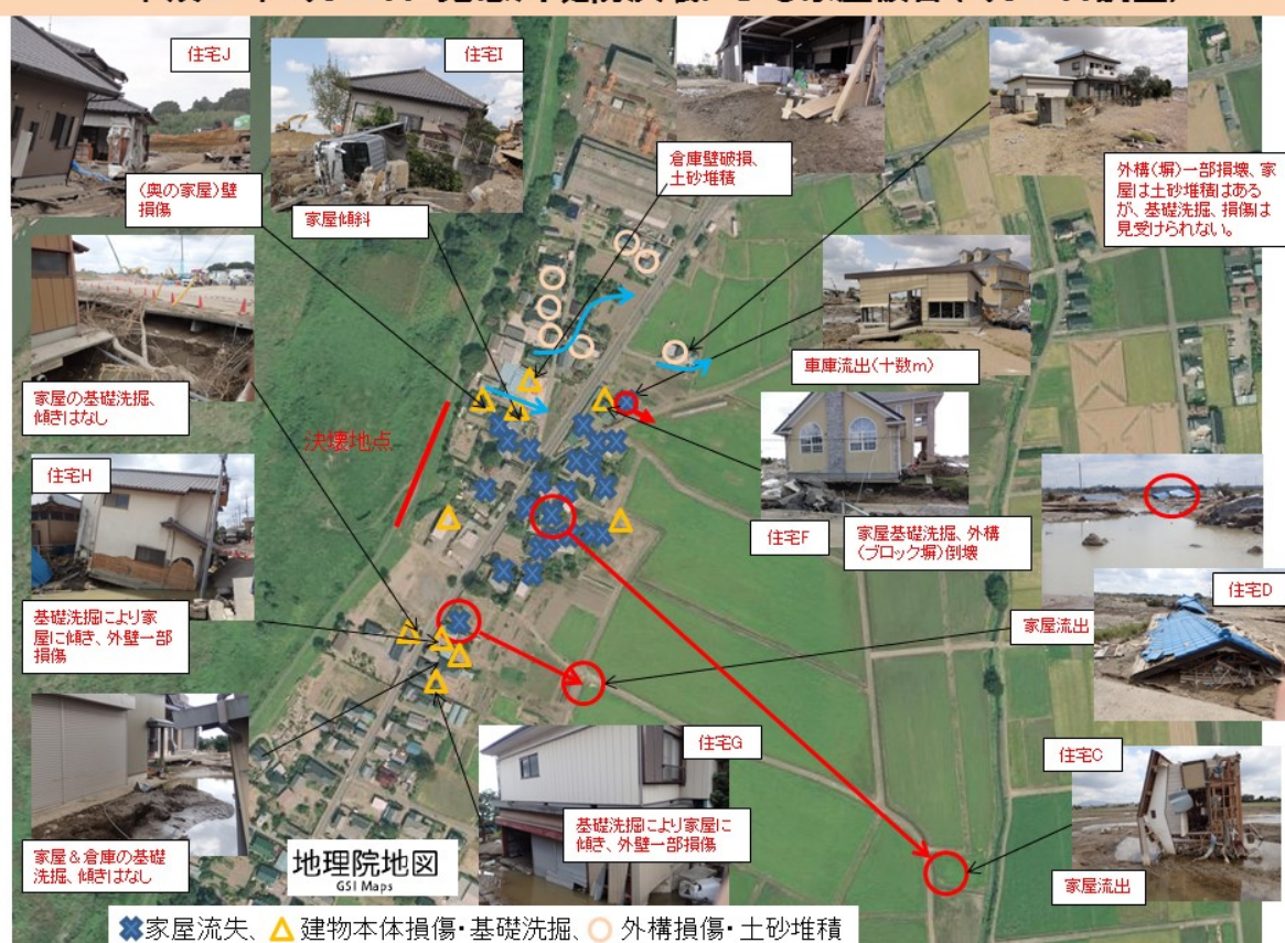
図1 堤防が決壊した地域での住宅等の被害分布 (国総研河川研究部水害研究室 作成)
