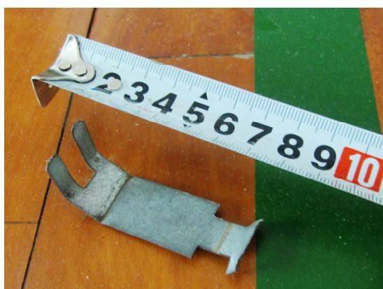
写真4-26 床に落下していたクリップ
