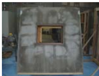
木造モルタル壁の 耐久性評価実験
