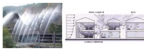
水膜システムによる延焼防止対策に関する実験 街区の延焼に関するシミュレーション技術の開発
