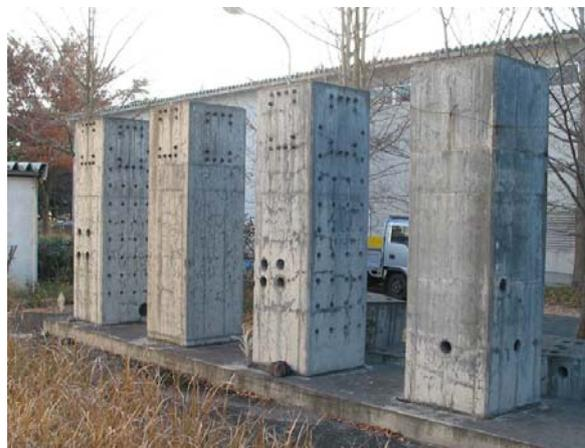
写真1 高強度コンクリート柱試験体
