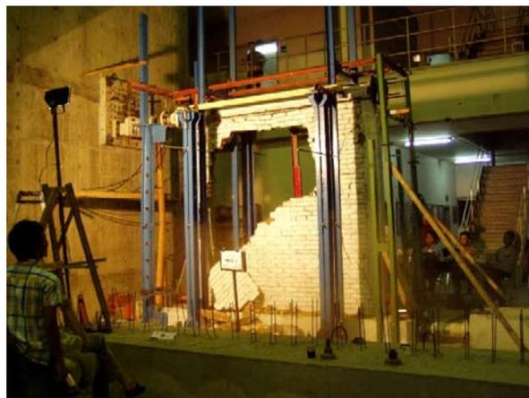
図3 繰り返し水平加力実験
