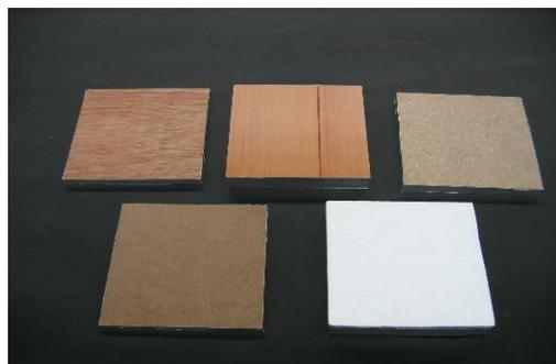
図-1 各種建築材料試験体：左上から、合板、フローリング、パーティクルボード、MDF、
