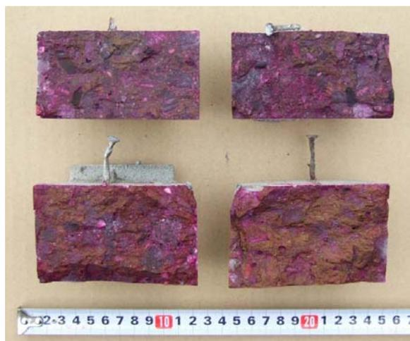
写真 4 材齢 15 年における中性化試験結果
