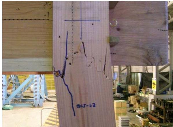
写真-2 曲げ破壊した柱（135mm）の状況
