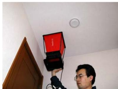
図-6 風量測定事例(フード式風量計)
