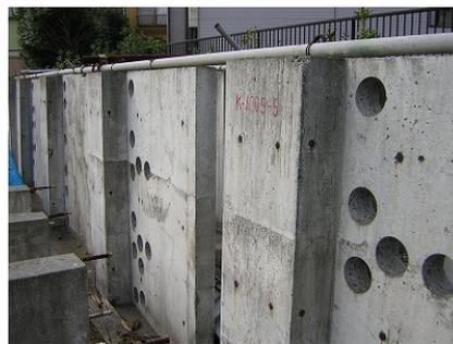
図 4 暴露 7 年目の柱付き壁試験体
