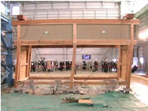
写真-1 曲げ破壊した試験体の全景
