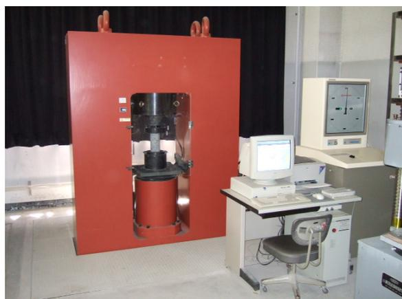
写真3 高強度コア供試体の圧縮強度試験
