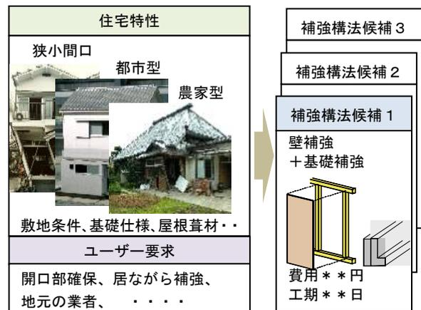
図6 木造住宅の補強構法選択システム
