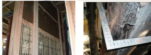
図4 水幕システムによる街区間延焼防止対策の有効性の検証
