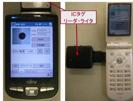
図4 施工現場で使用するツール
