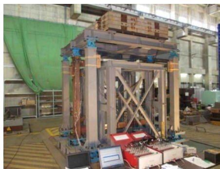
図3 引張ブレース骨組の振動台実験
