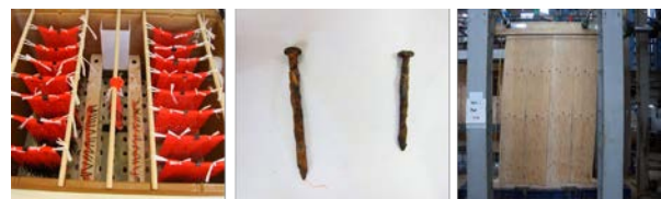
図3 塩水噴霧による釘の促進劣化と壁水平せん断試験の様子
