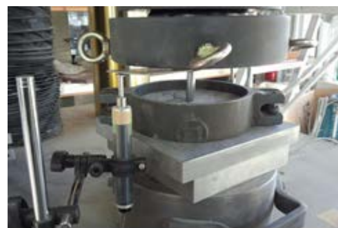
写真1 耐アルカリ試験の実施状況
