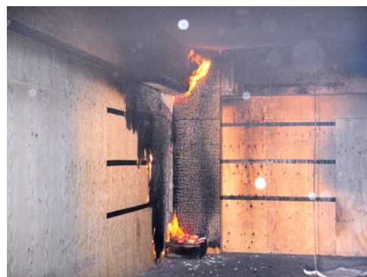
図3 天井を不燃化した火災実験における木質内装の燃え止まり(既往実験)
