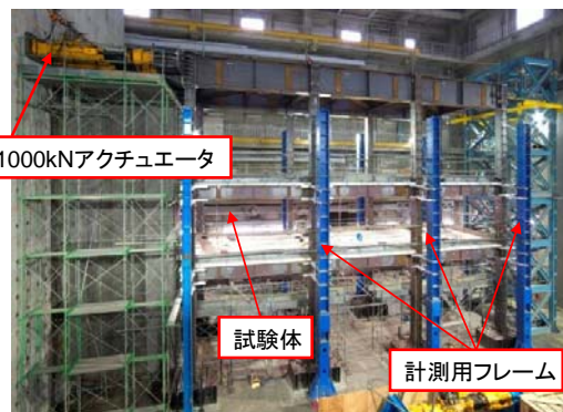
図5 鉄骨造実大3層骨組の載荷実験
