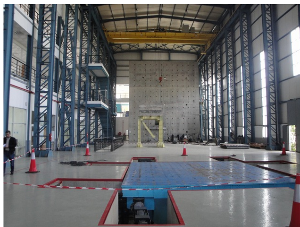
写真一1. 5. 2. 3 CGS 地震工学実験所アドバイザー(平成25年度～) アルジェリアCGS実験施設内部(手前:3次元震動台、奥:反力壁)
