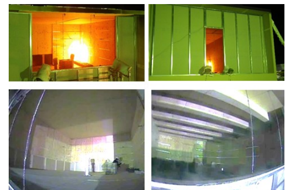
図7 開口条件や床面積、内装仕上げによるフラッシュオーバー遅延効果を確認する火災実験
