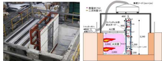
図4 ダブルスキンを構成するガラスの脱落時間に関する実大火災実験
