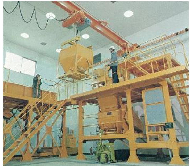
コンクリート実験室<2> バッチャープラント
