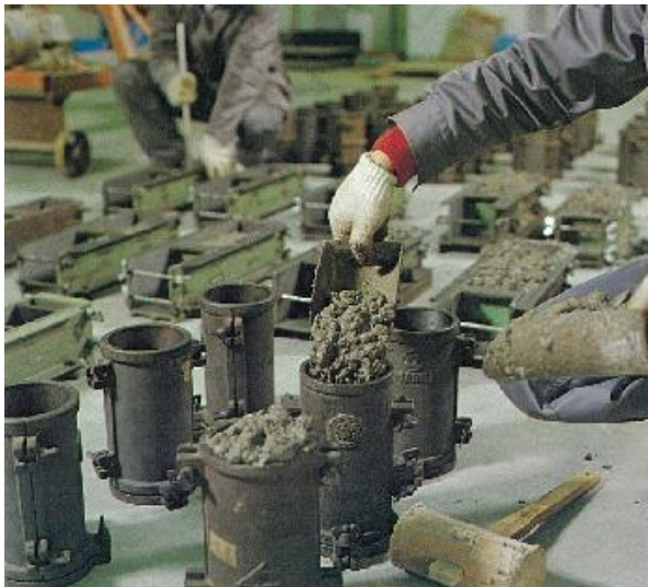
コンクリート実験室<1> コンクリートを練り混ぜ型枠につめる
