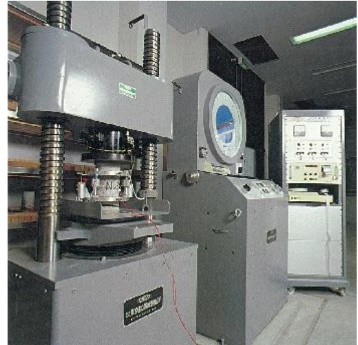
1000kN 圧縮試験機及び自動歪測定装置(コンクリートコア供試体の圧縮試験を行っているところ)
