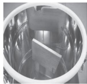
図2 試験片設置状況
