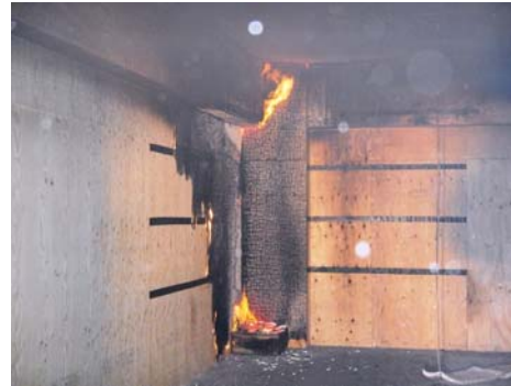
天井を不燃化して壁を木材で仕上げた区画の火災実験における燃え止まりの例（木三学実験）
