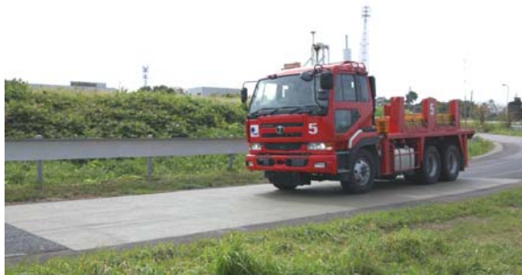
写真 1 促進載荷試験の様子
