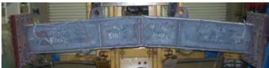
図-2 梁_崩壊耐力/崩壊温度
