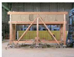
写真5 2008年試験体Aの破壊状況（錘3t、JMA神戸NS100%入力による）
