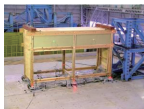
写真1 2008年試験体A 柱150mm角・柱脚緊結タイプ
