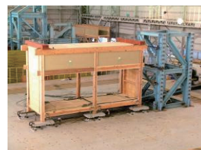
写真2 2008年試験体B 柱150mm角・柱脚移動タイプ
