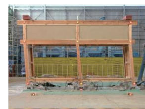
写真6 2009年試験体Aの破壊状況（錘2t、JMA神戸NS100%入力による）
