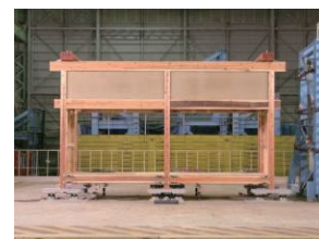
写真4 2008年試験体B 柱135mm角・柱脚移動タイプ
