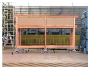
写真3 2008年試験体A 柱135mm角・柱脚緊結タイプ
