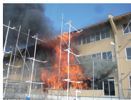
写真4 噴出火炎による上階延焼 (6分後)
