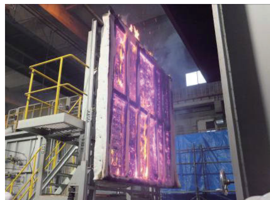
写真3 加熱試験直後の CLT パネル
