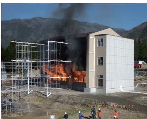
写真8 点火後131分 2階開口部からも噴出火炎
