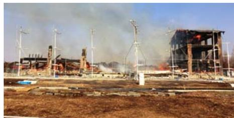
防火壁の倒壊後(96分後)
