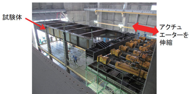
図6 鉄骨造建築物の多数回繰り返し加力実験
