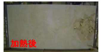
柱および床試験体の載荷加熱試験の状況
