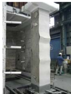
柱および床試験体の載荷加熱試験の状況
