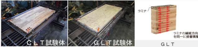
図 試験体の概要
