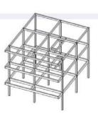
外壁・内装全撤去 スケルトン化
