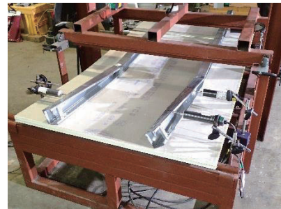
写真 3 LGS 間仕切壁の実験(載荷後)
