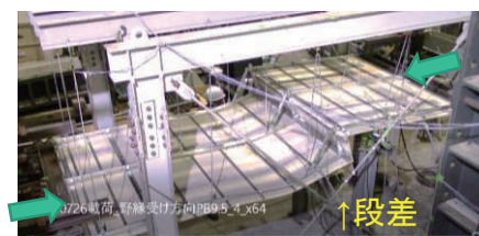
(a) 在来工法天井の段差部
