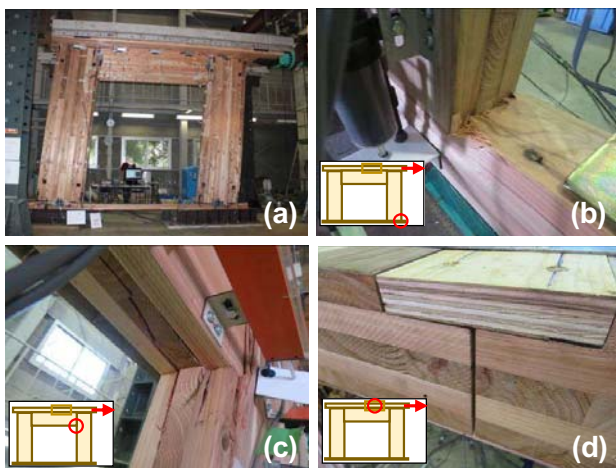
図5 垂れ壁付きフレームの破壊性状
