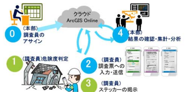
図 9 応急危険度判定支援ツールの導入による調査オペレーションイメージ
